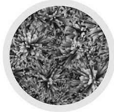
2000-ჯერადი გადიდებით მიღებული გამოსახულება SBTC-ის საფარის კრისტალური სტრუქტურა
